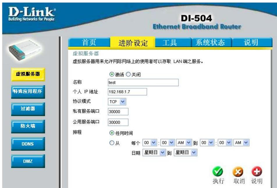
(图9) 端口映射配置
