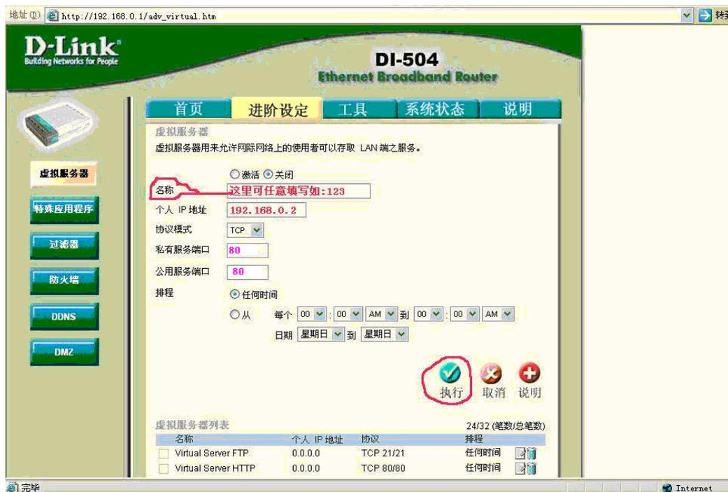
第四步：在私有服务端口和公有服务端口处填上跟我们软件相一致的上线端口号，安装时默认的端口号是 80，个人 IP 地址处填写你的本机 IP 地址(此 IP 在 dos 命令符下键入 ipconfig 可得到) 如这里的本机 IP 为 192.168.0.2；协议处请选择 TCP，按执行！到此端口设置已完成。
